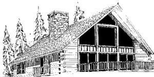
*Casa de Troncos* le ofrece un sistema constructivo que consiste en la utilización de troncos de **pino Elliotti**, tratados con productos ecológicos y trabajados con una máquina de alta tecnología, única en la Argentina, capaz de moldurar en una sola pasada los troncos que formarán las paredes.
